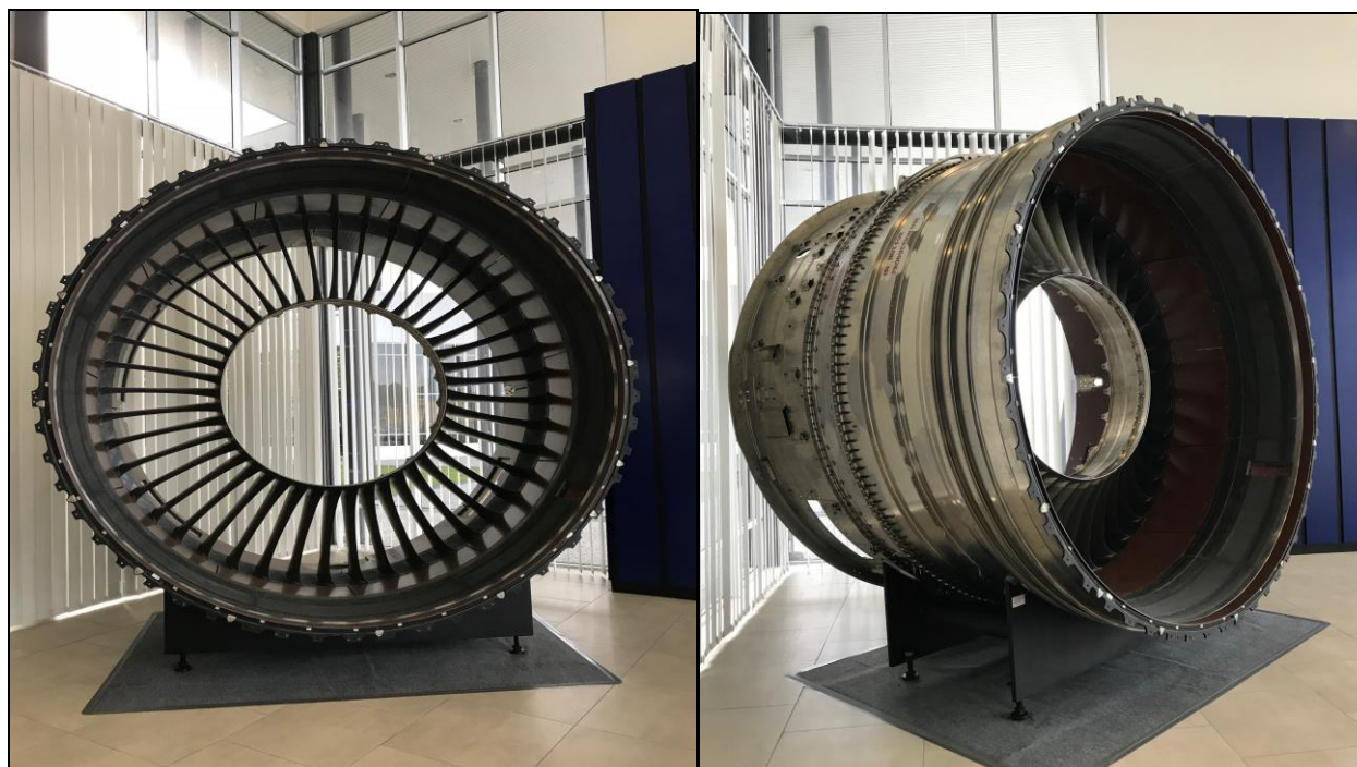
Figure 2: Rolls-Royce fan case
